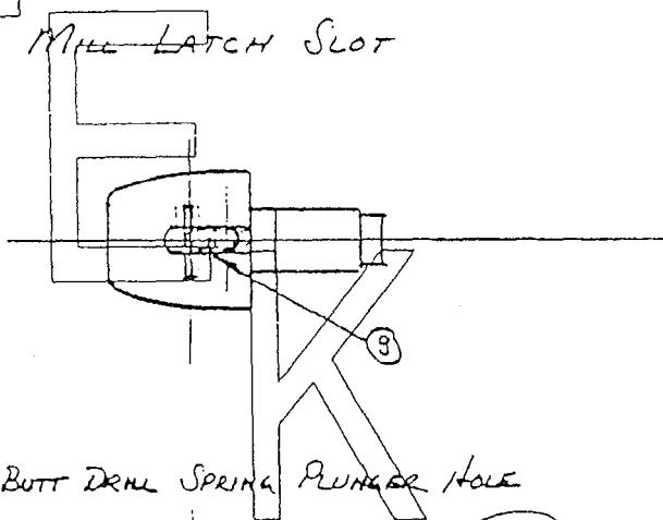
STA. 6 - ⑩ BUTT DRILL SPRING PLUNGER HOLE
